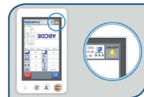
Включение и выключение LED подсветки рабочего поля в одно касание
