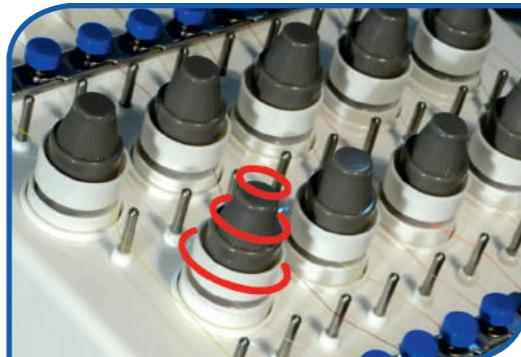
Запатентованная система датчика обрыва нити
