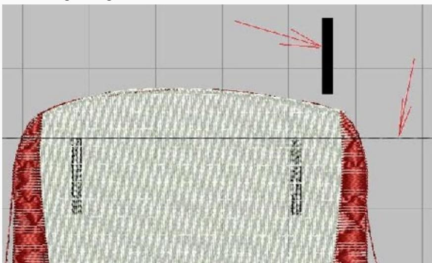
а) Петли на рубашке. Они должны вырезаться и чтобы нам в последствии, при разрезании не повредить нитки, мы изначально должны вырезать петли из объекта рубашка. Для этого выбираем инструмент Rectangle и рисуем нужную нам петлю. Затем копированием создаем вторую. После чего располагаем их в нужном порядке. Поскольку в любимом мною Вилкоме, черт его побери, нет направляющих, то я рисую себе вспомогательные линии и располагаю объекты...
