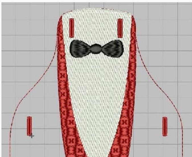
С петлями покончено. И рубашка почти нарисовалась. Теперь осталось добавить разные линии, которые я сделала инструментом Input C с заливкой Contour. Заливки и инструменты на усмотрение.
